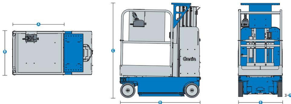
(1) Altura de trabajo = Altura de la plataforma + 2 m
